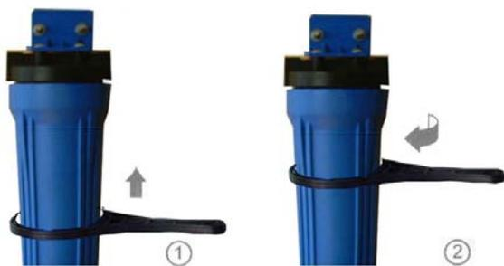
(2) 将专用的锁紧扳手如图①套在初滤桶的最上端。
